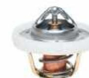
Термостат бескорпусной (термозлемент)
