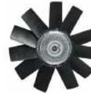
Муфта электромагнитная привода вентилятора
