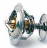
Термостат бескорпусной (термозлемент)
