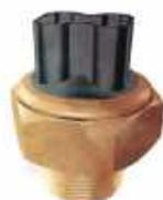
Датчик включения вентилятора
